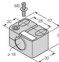
Abrazadera de montaje para sensores de tubo roscado, con tope fijo; material: PA6
