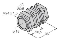
Abrazadera de montaje rápido con tope, material: Latón cromado. Rosca macho M24 × 1.5. Nota: La distancia de conmutación de los interruptores de proximidad puede variar por el uso de soportes de montaje rápido.
