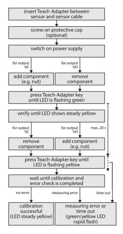
La señal de medición en el sensor está influenciada por el diámetro y las propiedades del material de la espiga de centraje y del componente, pero también por el recubrimiento de la zona activa. Por lo tanto, cada sensor debe estar condicionado al entorno operativo; es decir, a los manguitos aplicados o los tapones de cierre y el objetivo (tuerca, manguito, etc.). Para configurar un sensor, se requiere el adaptador de programación VB2-SP1 disponible de Turck.
