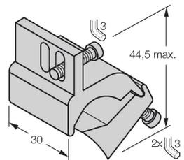
Soporte de montaje para el montaje de sensores de campo magnético en cilindros de tirantes; diámetro del cilindro: 50...125 mm; material: Aluminio
