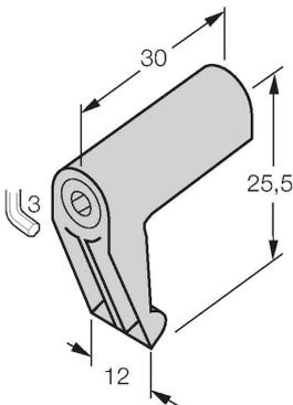
Soporte de montaje para el montaje de sensores de campo magnético en cilindros de tirantes; diámetro del cilindro: 32...100 mm; material: Fundición inyectada de zinc
