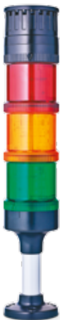
Número de artículo: ECO70-Q31 Colores: rojo-naranja-verde Función: Indicador LED luz fija, zumbador con tono continuo o de pulso Tensión nominal: 24 V CA/CC Tipo de montaje: Montaje de tubos (tubo de 100 mm de longitud)
